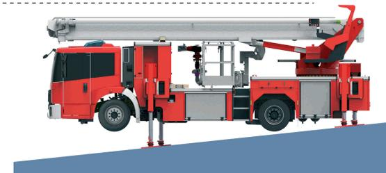
Hubrettungs Bühnen / HAB bei einer längsgeneigten Standfläche von >3° immer hangabwärts positionieren!
